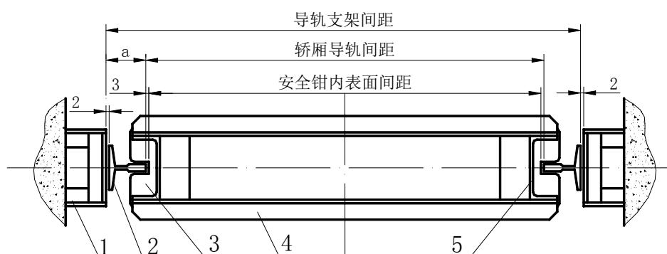
图 4-1 轿厢导轨支架间距示意
