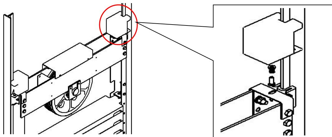
图 10-9 对重油杯安装图
