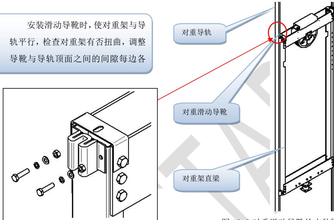
图 10-2 对重滑动导靴的安装图
