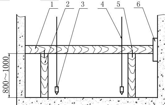
图 4-4 底坑样板架
