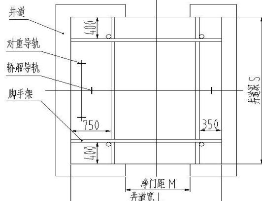
图 3-3 单井字脚手架平面图
